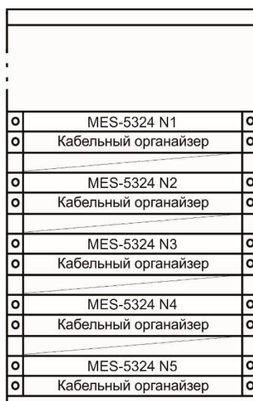
Рисунок 46 — Размещение коммутаторов MES5324 в стойке
