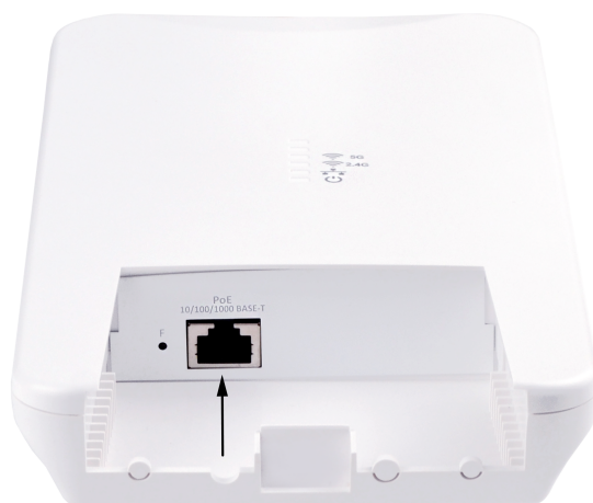
Рисунок 13 – Подключение Ethernet-кабеля к PoE-порту
