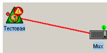
Рисунок 34 – Отображение замаскированных аварий на объекте
