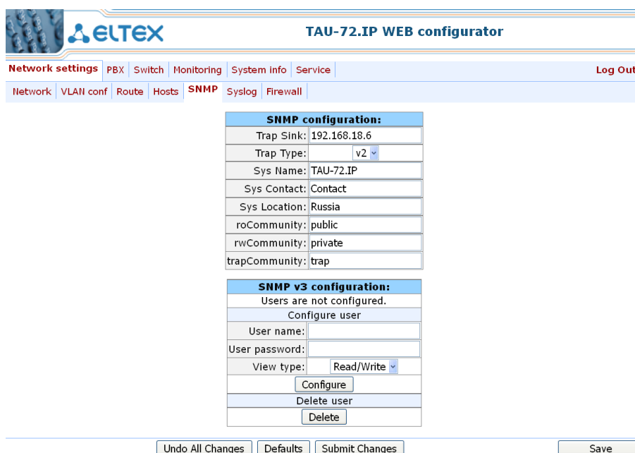
Рисунок 2.3 – Настройка протокола SNMP
