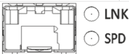
Рисунок 15 – Расположение индикаторов разъема SFP
