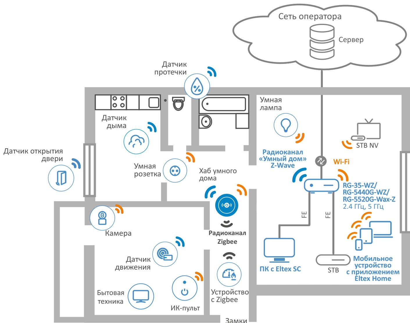
Схема работы Eltex SC с абонентскими терминалами NTU-RG-5420G-WZ, NTU-RG-5440G-WZ
