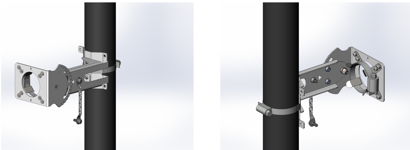
Рисунок 11 — Установка кронштейна на трубостойку
