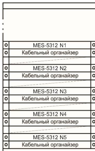
Рисунок 81 – Размещение коммутаторов MES5312 в стойке
