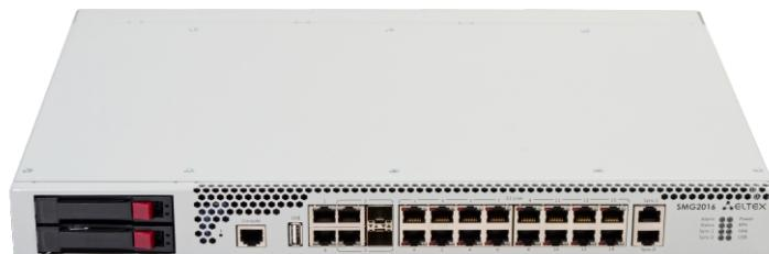
**Гибридная платформа SMG-2016** может использоваться в качестве транкового шлюза для сопряжения сигнальных и медиапотоков TDM- и VoIP-сетей, IP-АТС с поддержкой функций ДВО и СОРМ, а также выступать универсальным решением для построения инфокоммуникационных сетей связи нового поколения. Широкая функциональность, строгое соответствие стандартам и высокая надёжность операторского класса позволяют решать на базе SMG-2016 большинство возникающих у операторов и сервис-провайдеров задач.
