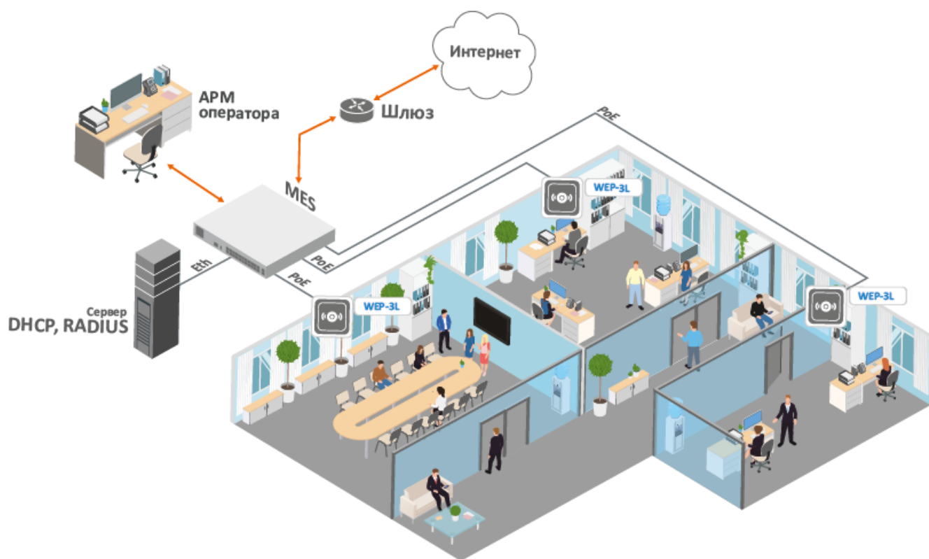
Рисунок 1 – Функциональная схема использования WEP-3L
