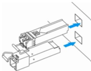
Рисунок 94 – Установка SFP-трансиверов
