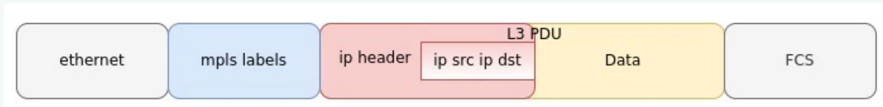
Для L2VPN: ESR попытается «заглянуть» в ethernet-фрейм (который находится за mpls-заголовком) и получить ip-src и ip-dst в ip-заголовке для добавления в расчет хеша.
