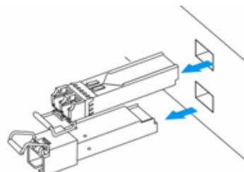
Рисунок 97 – Извлечение SFP-трансиверов
