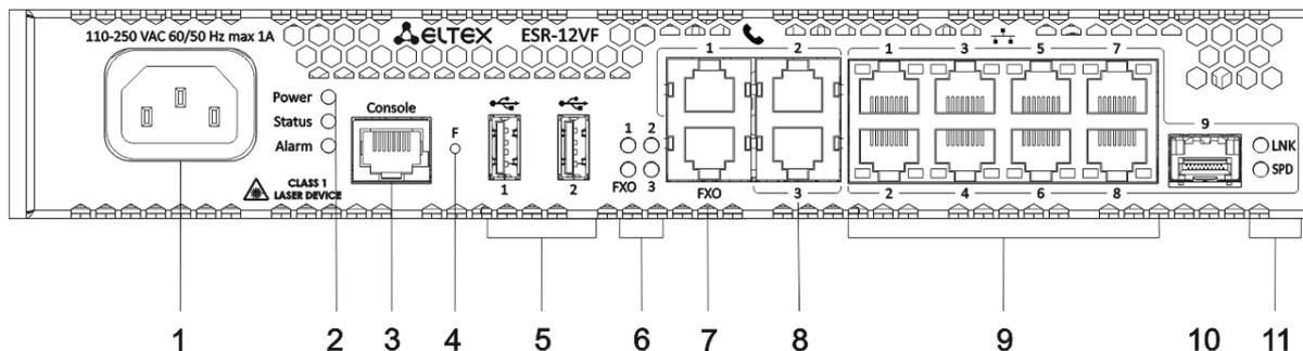
Рисунок 60 – Передняя панель ESR-12VF
