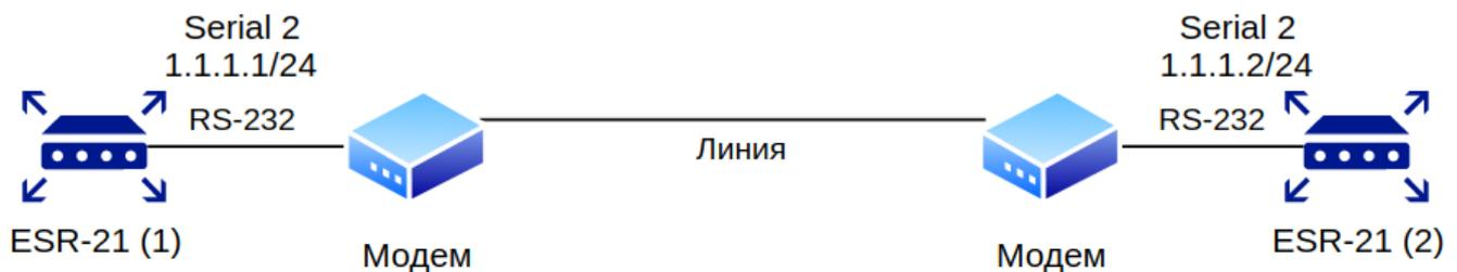
⚠ Модемы должны быть предварительно введены в режим автоматической установки соединения.
