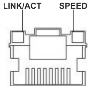
Рисунок 71 – Расположение индикаторов разъема RJ-45
