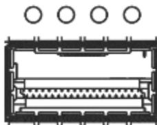
Рисунок 75 – Расположение индикаторов QSFP+/QSFP28 интерфейса для ESR-3300
