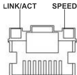
Рисунок 82 – Расположение индикаторов разъема RJ-45
