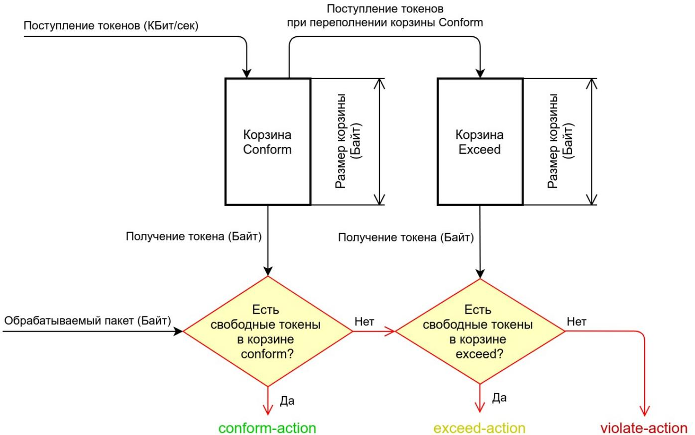
У такого механизма есть две корзины токенов (conform и exceed), каждая из которых имеет свой размер. Conform-корзина наполняется токенами до определенного размера с течением времени. Корзина exceed наполняется излишками токенов корзины conform.
