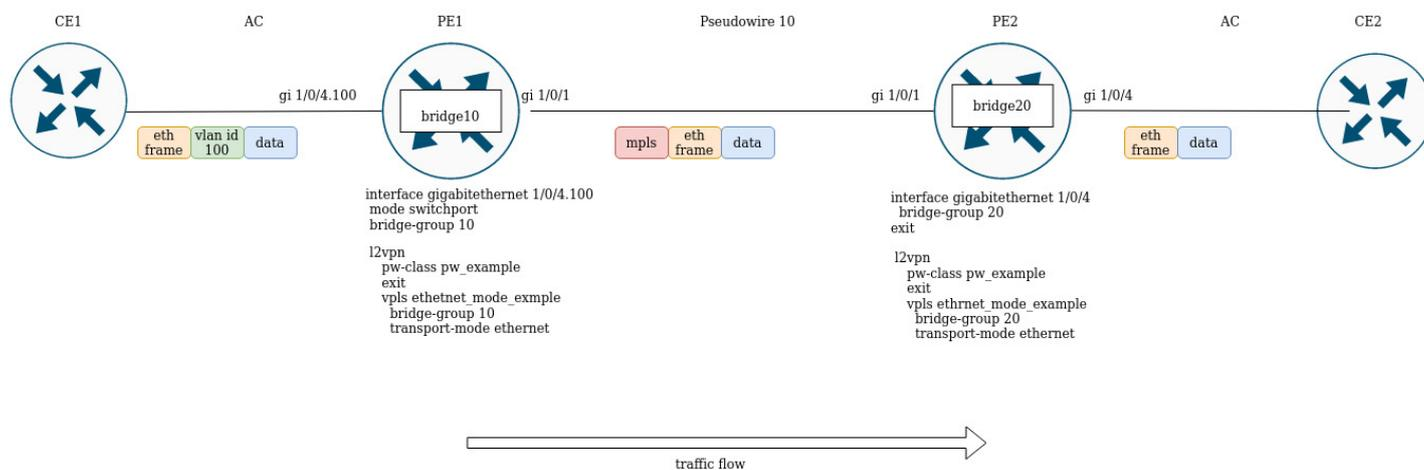
Предположим, PE1 и PE2 сконфигурированы в ethernet mode. Со стороны PE1 в бридж-домен включен саб-интерфейс gigabitethernet 1/0/4.100, поэтому vlan-тег (vlan id 100) с входящего трафика будет удален перед помещением в Pseudowire 10 (соответственно, восстановлен при трафике в сторону AC). С другой стороны, AC на PE2 является интерфейсом, значит трафик будет проходить без модификаций в обоих направлениях.
