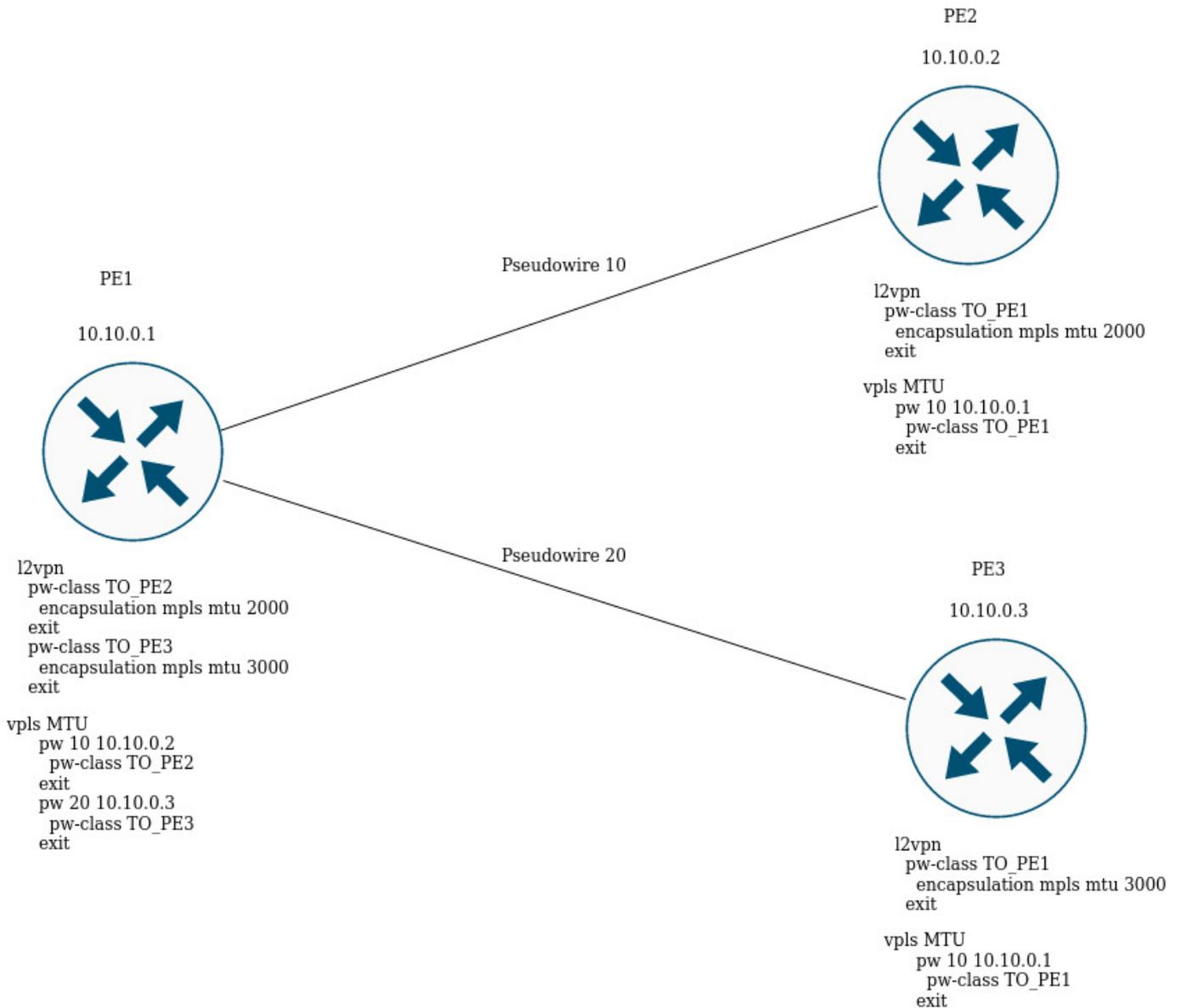
На рисунке выше PE1 поднимает два псевдо-провода: pseudowire 10 до PE2, и pseudowire 20 до PE3 соответственно. Для сигнализации с PE2 MTU будет равным 2000 (pw-class TO\_PE2), для PE3 – MTU будет равным 3000 (pw-class TO\_PE3).
