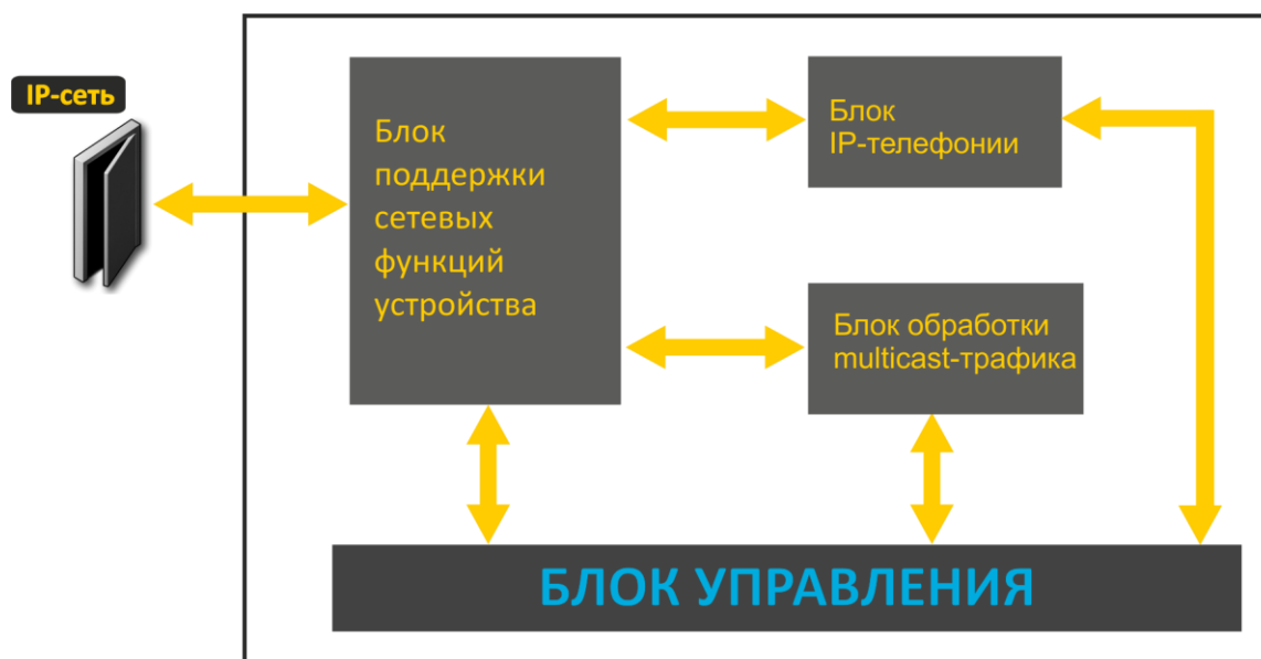
Рисунок 3 — Функциональная схема устройства серии TAU-1M.IP
