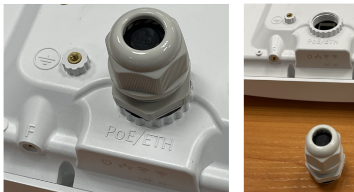
Рисунок 12 – Снятие кабельного ввода
