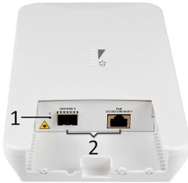
Рисунок 3 – Внешний вид нижней панели WOP-3ax-LR6
