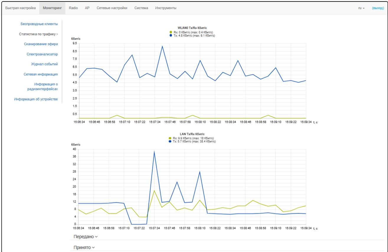
График LAN Tx/Rx показывает скорость приема/передачи трафика через Ethernet-интерфейс устройства за последние 3 минуты. График автоматически обновляется каждые 6 секунд.
