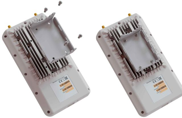
Рисунок 7— Крепление кронштейна к устройству
