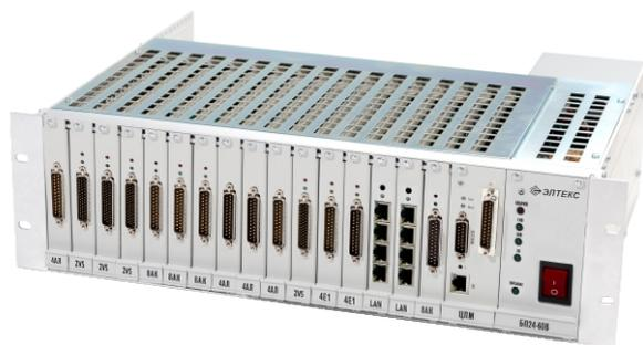
Гибкий мультиплексор МАКОМ-МХ предназначен для формирования первичных цифровых потоков со скоростью 2048 Кбит/с (поток E1) и передачи по ним аналоговых речевых сигналов и сигналов цифровых интерфейсов, электронной кроссовой коммутации цифровых каналов со скоростью 64 Кбит/с, передачи цифровых потоков по сети IP/Ethernet, для конвертации физических стыков и линейной сигнализации.
