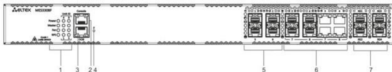
Рисунок 5 — Передняя панель MES3308F
