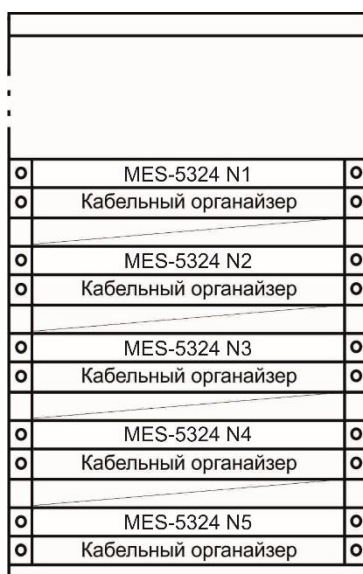
Рисунок 46 — Размещение коммутаторов MES5324 в стойке
