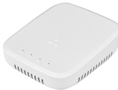
**ONT NTU-1L** — абонентские терминалы, предназначенные для подключения пользователей к сети передачи данных по технологии GPON.
