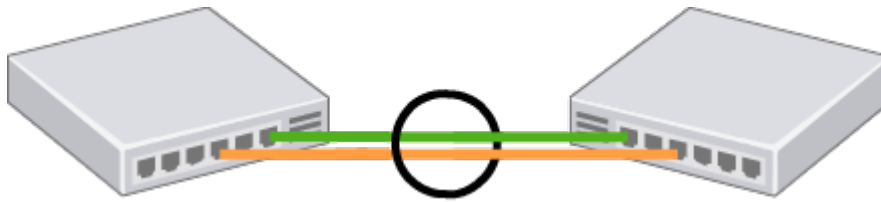
Рисунок 27 – Объединение нескольких физических каналов в группу агрегации
