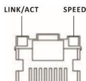
Рисунок 54 – Внешний вид разъема RJ-45
