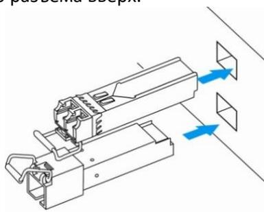
Рисунок 59 – Установка SFP-трансиверов
