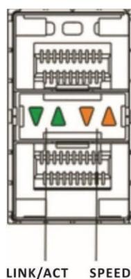
Рисунок 53 – Внешний вид сдвоенного разъема SFP/SFP+
