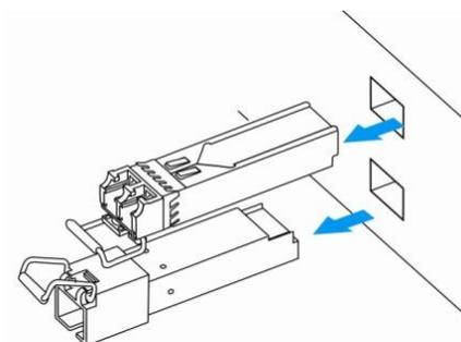
Рисунок 62 – Извлечение SFP-трансиверов
