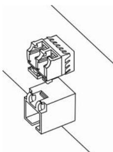
Рисунок 60 – Установленные SFP-трансиверы
