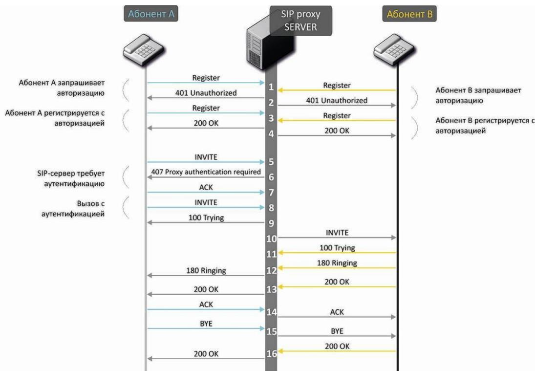
Рисунок 23 – Алгоритм вызова с участием SIP проху-сервера
