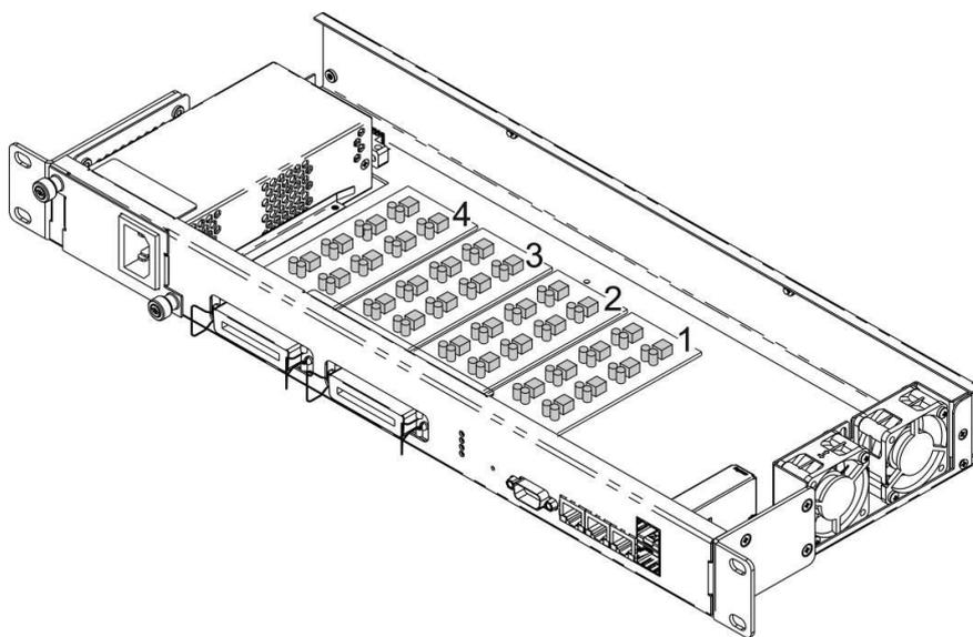
Рисунок 14 – Расположение submodule в TAU-32M.IP
