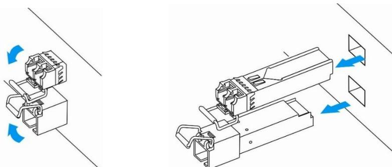
Рисунок 16 – Открытие защелки SFP-трансиверов и извлечение SFP-трансиверов
