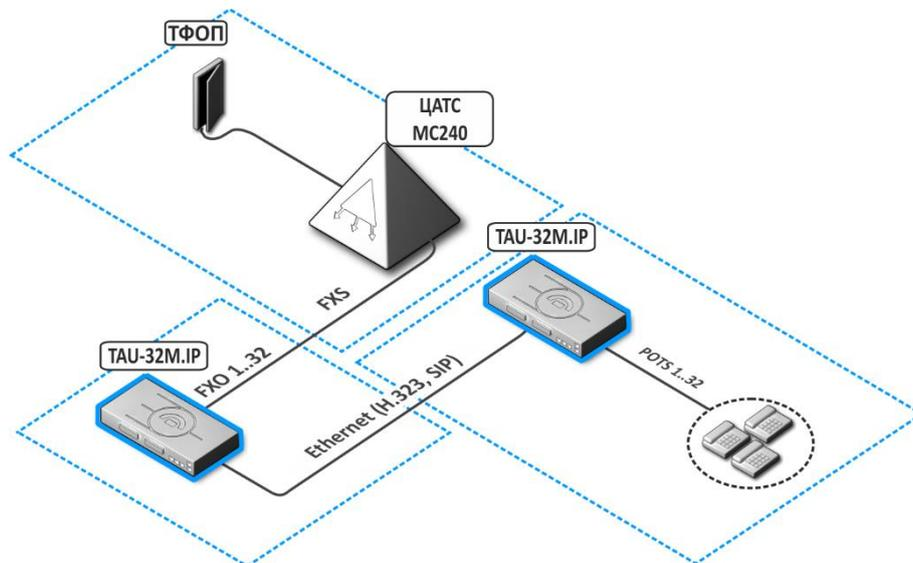
Рисунок 3 – Схема использования TAU-32M.IP в режиме точка-точка
