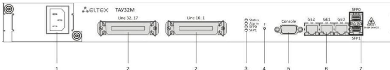
Рисунок 7 – Внешний вид передней панели TAU-32M.IP
