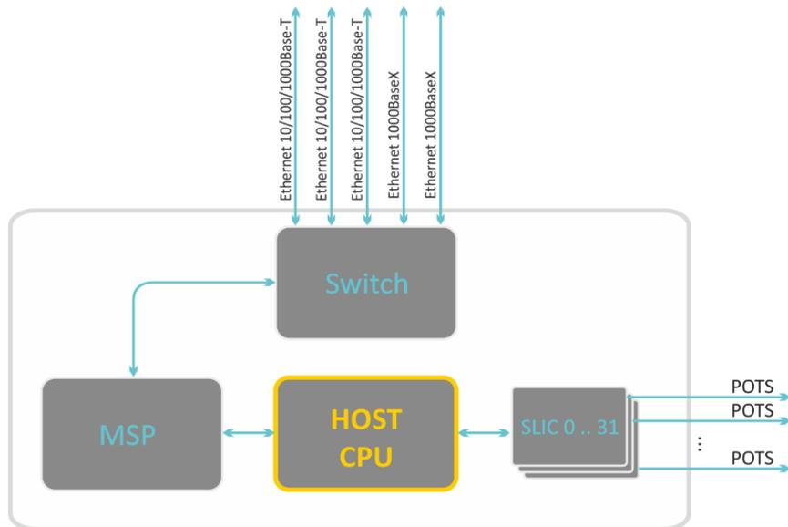
Рисунок 6 – Функциональная схема TAU-32M.IP
