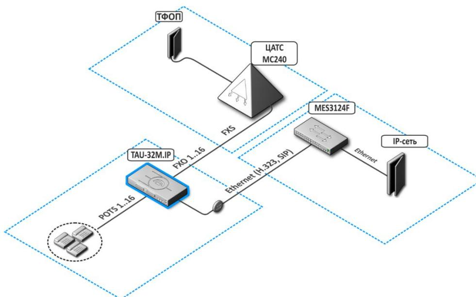
Рисунок 5 – Схема использования TAU-32M.IP в качестве FXS+FXO
