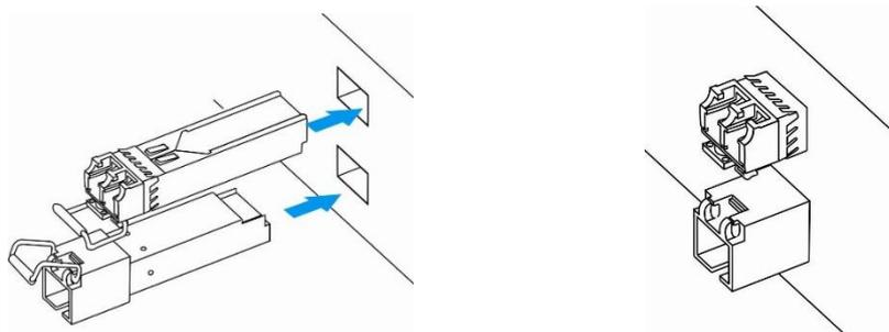
Рисунок 15 – Установка SFP-трансиверов
