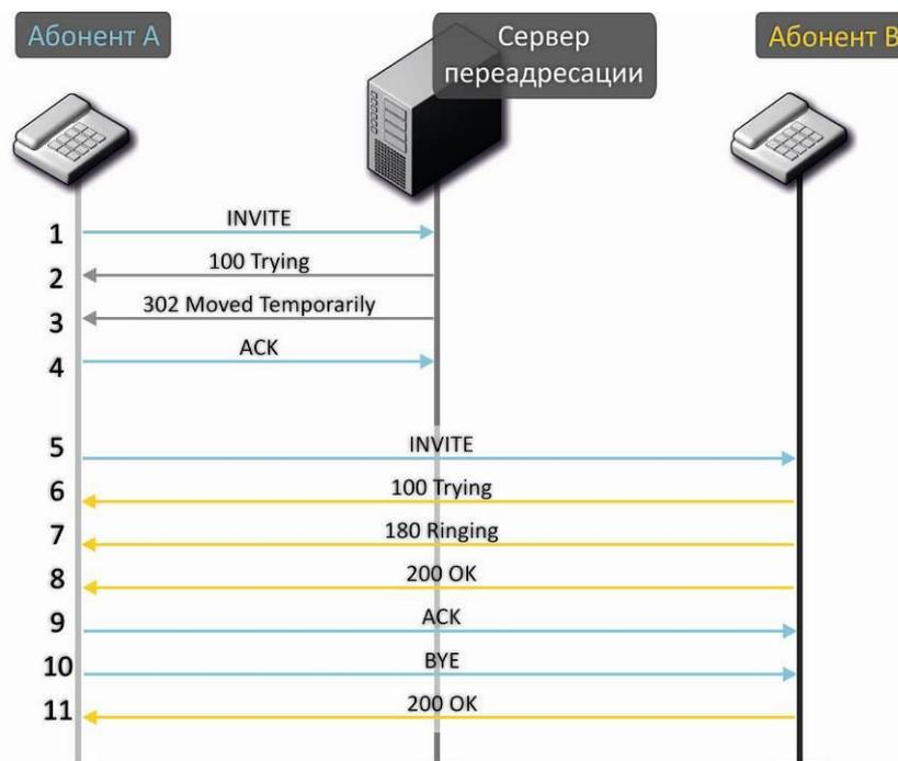
Рисунок 24 – Алгоритм вызова с участием сервера переадресации
