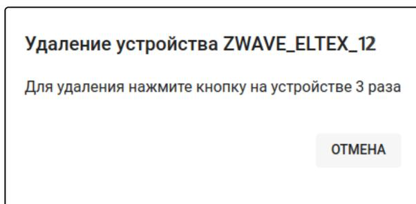
Нажмите сервисную кнопку на удаляемом устройстве 3 раза. Хаб начнет удаление этого устройства.
