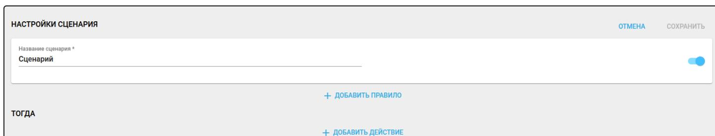
В поле **Сценарий** введите имя сценария, например «Входная дверь», затем нажмите кнопку **Добавить правило** в разделе **Если**. Выберите вкладку в зависимости от желаемого условия и заполните необходимые параметры. В данном примере во вкладке **Устройства** выберите датчик и значение, которое он возвращает («Открыто»).
