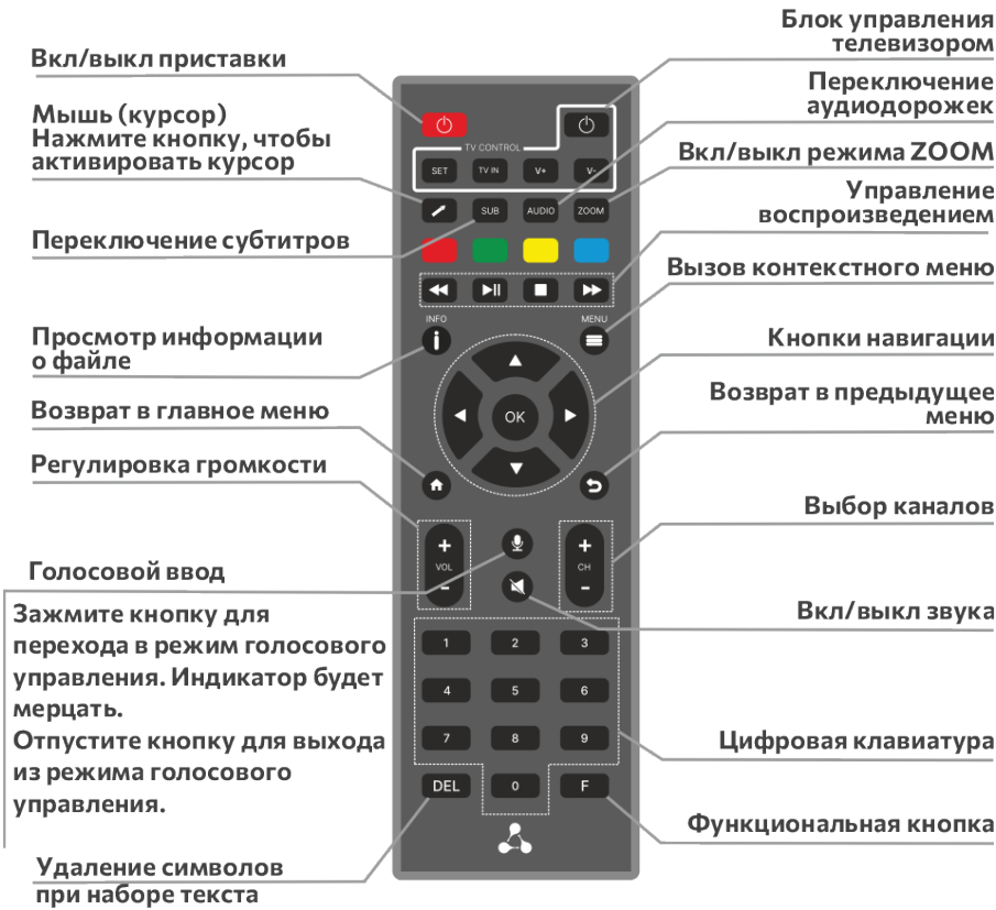
Рисунок 7 – Универсальный Bluetooth-пульт дистанционного управления «Eltex Bluetooth RC» Bluetooth-пульт дистанционного управления работает одновременно в двух режимах:
