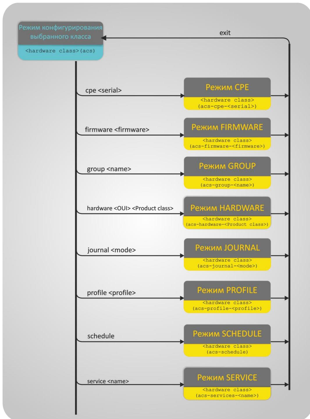
Рисунок 2 — Иерархия командных режимов блока «<hardware class>(acs)»
