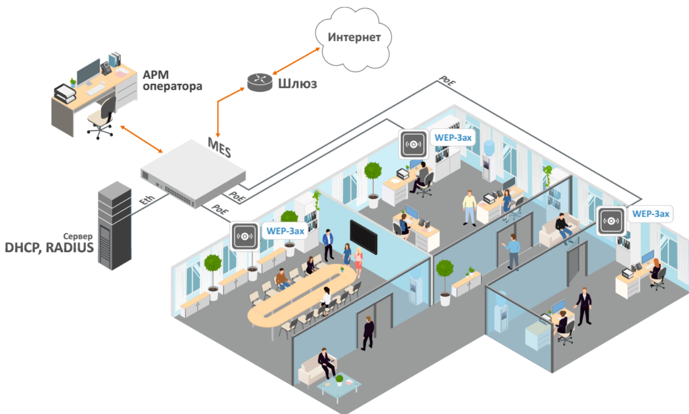
Рисунок 1 — Функциональная схема использования WEP-3ax
