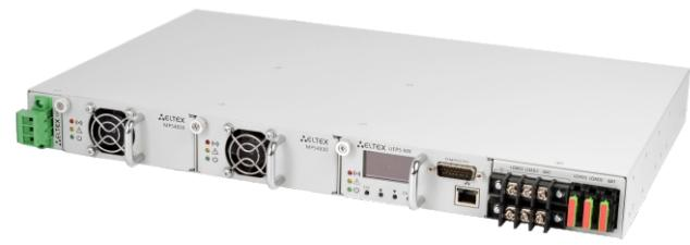
Устройство UEP5-2 предназначено для обеспечения электропитанием телекоммуникационного оборудования производства ЭЛТЕКС или других производителей с номинальным входным напряжением 48 В постоянного тока и мощностью до 3 кВт (60 А), а также для заряда свинцово-кислотной аккумуляторной батареи. UEP5-2 представляет собой модульную электропитающую установку, конструктивно выполненную в виде типового 19" каркаса высотой 1U.
