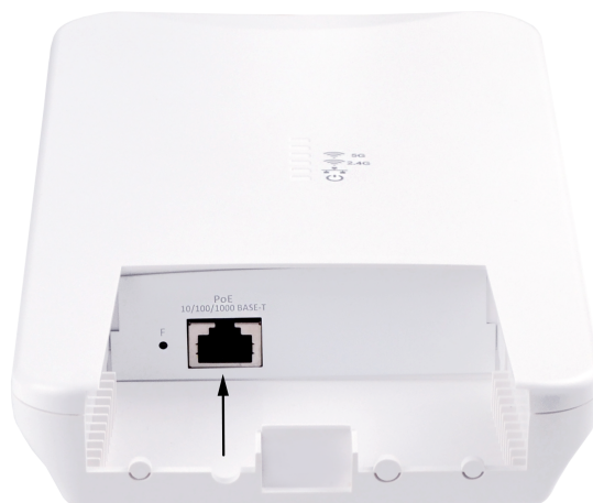
Рисунок 15 — Подключение Ethernet-кабеля к PoE-порту
