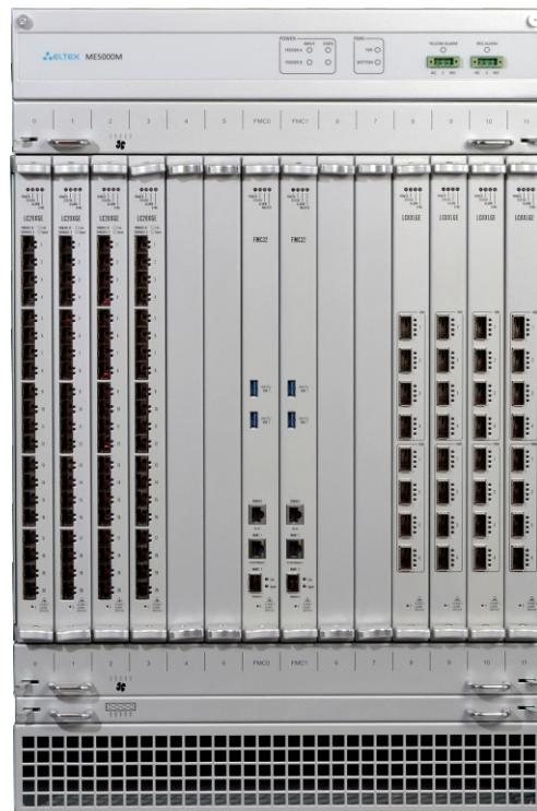
Модули маршрутизатора устанавливаются в шасси — стандартный 19" евроконструктив высотой 15U. В шасси предусмотрены 2 слота для установки модулей управления и коммутации и 12 слотов для установки линейных карт.
