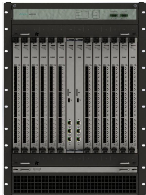
Модули маршрутизатора устанавливаются в шасси — стандартный 19" евроконструктив высотой 15U. В шасси предусмотрены 2 слота для установки модулей управления и коммутации и 12 слотов для установки линейных карт.
