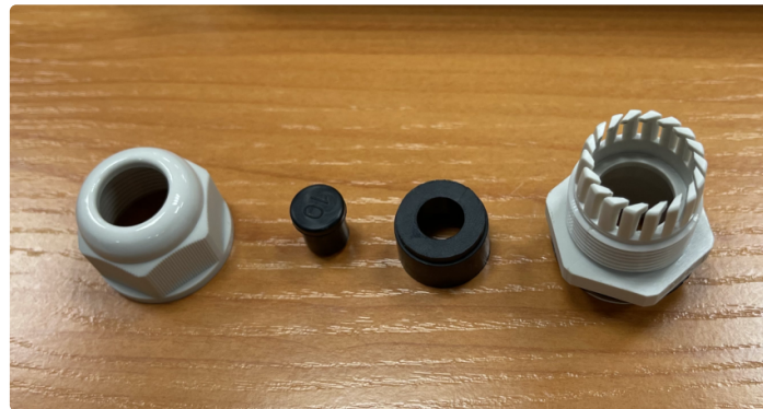
Рисунок 13 – Кабельный ввод в разобранном виде
