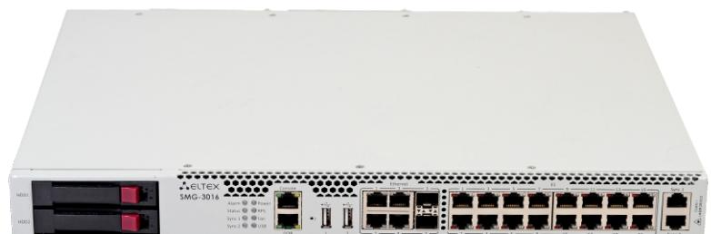
**Гибридная платформа SMG-3016** предназначена для трансляции сигнальных и медиаданных между пакетными и традиционными сетями. Прозрачная передача сигнализации SS7 и DSS1 (Q.931) через пакетные сети осуществляется благодаря поддержке протоколов M2UA и IUA из стека SIGTRAN. Управление медиаканалами осуществляется по протоколам H.248/MEGACO или MGCP.
