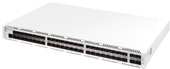
Коммутаторы нового поколения MES3400-48F могут использоваться в операторских сетях в качестве коммутаторов уровня агрегации района или транспортных коммутаторов. Они имеют значительный запас по производительности благодаря универсальным интерфейсам, работающим на скорости 10 Гбит/с или 1 Гбит/с. Преимущества коммутаторов агрегации MES – развитые функции L2, поддержка статической и динамической маршрутизации, резервирование источников питания с возможностью горячей замены.
