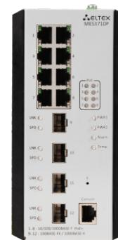
Промышленные коммутаторы MES3710P предназначены для организации защищенных отказоустойчивых сетей передачи данных на объектах, где необходимо выполнение требований по обеспечению устойчивости к воздействиям различного вида: температурным, механическим, вибрации и др. Данные коммутаторы имеют в своем составе гигабитные порты 10/100/1000BASE-T с поддержкой PoE/PoE+, а также порты 100BASE-FX/1000BASE-X (SFP).
