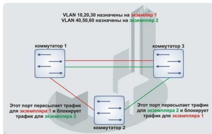
Рисунок А.1 – Настройка протокола множества связующих деревьев
