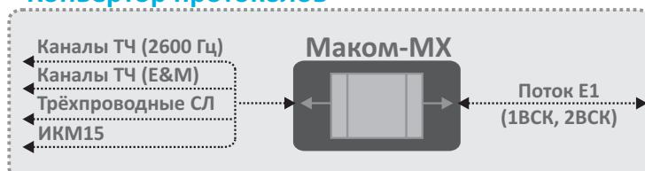
Аппаратура позволяет производить конвертирование протоколов тональной сигнализации каналов ТЧ (2600Гц) в протоколы сигнализации 2ВСК потоков E1 и обратно (не более 60 каналов ТЧ).
