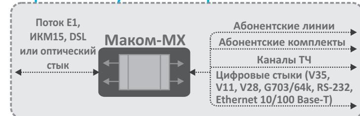
В режиме оконечного мультиплексора аппаратура позволяет подключать устройства через аналоговые и цифровые стыки и осуществлять соединение с удаленными устройствами по потокам E1, ИКМ15 или по оптическому кабелю по технологии TDMoP.
