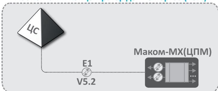
При использовании процессора ЦПМ, оборудование Маком-МХ позволяет создавать абонентские концентраторы от АТС (БКП-М) или другой АТС по протоколу V5.2.
