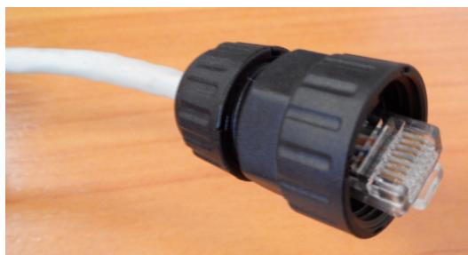
Рисунок 16 – Вид закрепленной на кабеле ответной части
