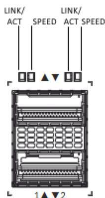
Рисунок 17 — Внешний вид панели индикации интерфейсов QSFP28
