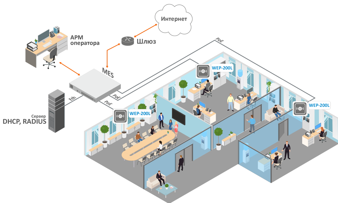
Рисунок 1 – Функциональная схема использования WEP-200L
