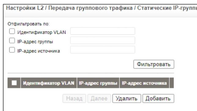
Для того чтобы отобразить и отсортировать записи в таблице по номеру VLAN, IP-адресу или IP-адресу отправителя установите один из следующих флагов, заполните соответствующие поля и нажмите кнопку «Отфильтровать по»:
