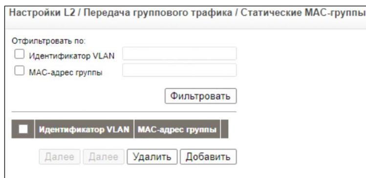
Для того чтобы отобразить и отсортировать записи в таблице по номеру VLAN или по групповому MAC-адресу установите один из следующих флагов, заполните соответствующие поля и нажмите кнопку «Фильтровать»:
