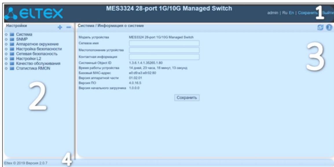
Рисунок 1 — Элементы навигации Web-конфигуратора
